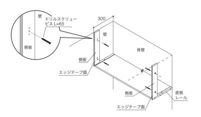
[側板固定用下穴位置] 側板の上下方向に注意してください。
