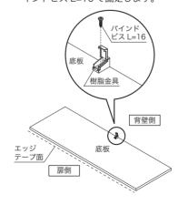
**3** 樹脂金具を取り付けた底板を底板レールに沿って入れ込みます。
